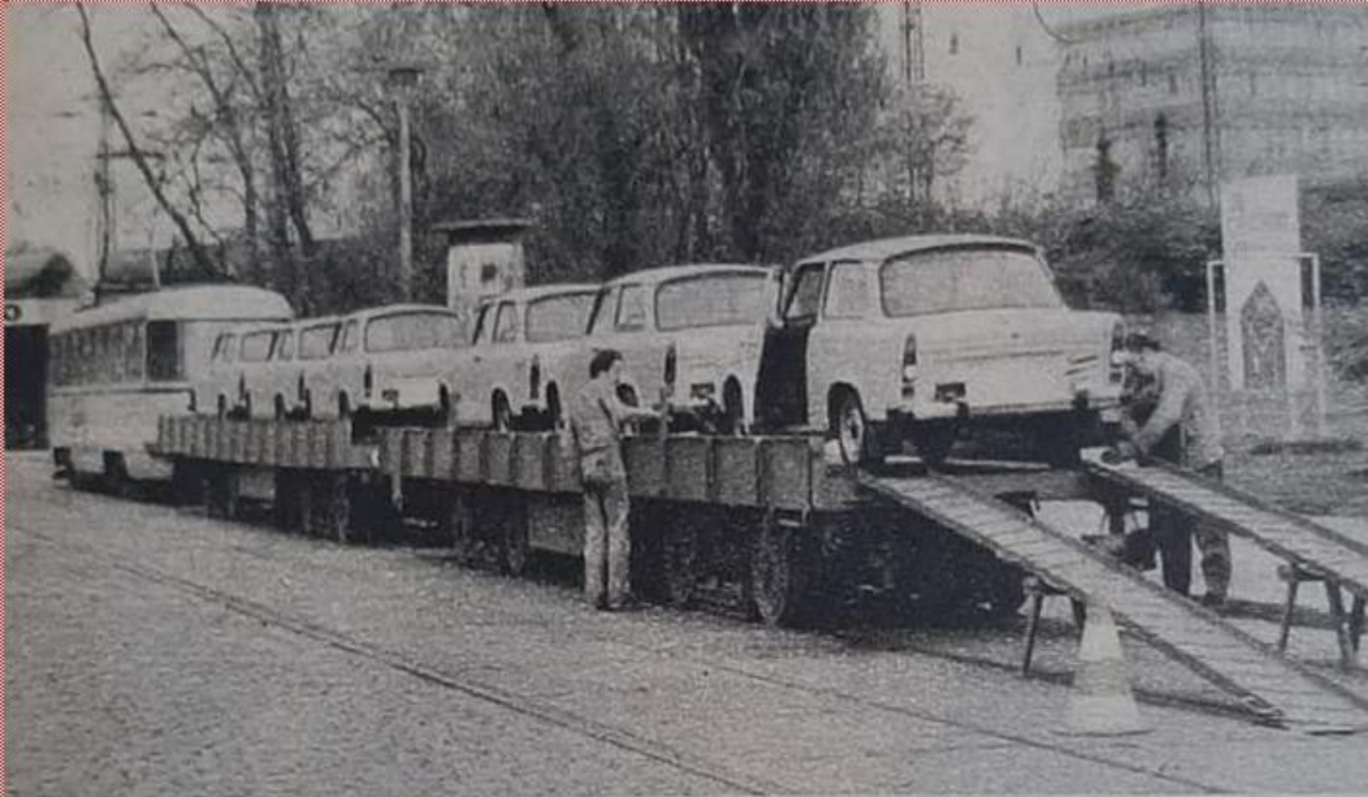
kw-Transport per Straßenbahn in Magdeburg
