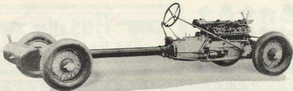
Der hochmoderne Zentralrohrrahmen des Tatra 80
