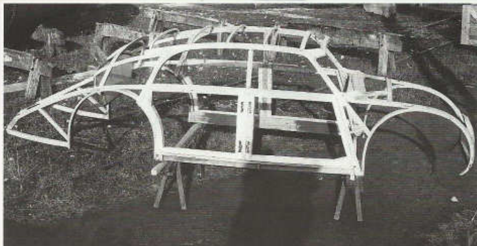
Dřevěná kostra karoserie T 77 je unikátní dílo. Ta na fotografiil je z časů sériové výroby
