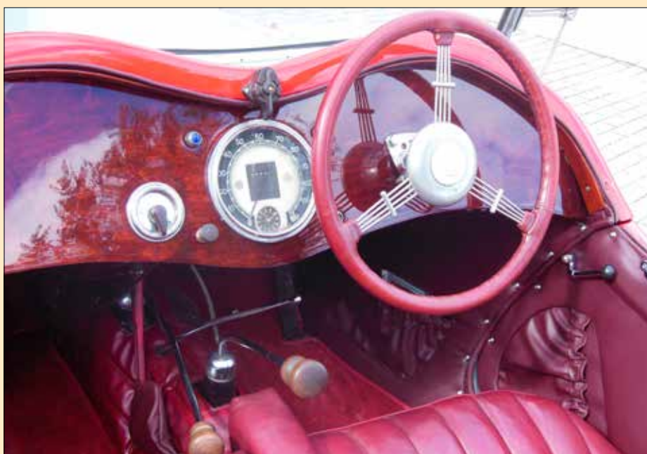
Všimněte si tří pák na převodovce, kterým ještě sekunduje ruční brzda. Pokud si na ně zvyknete, jsou opravdu všechny využitelné
