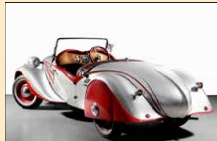
Zajímavým konstrukčním prvkem je samostatně otevíratelný spodní díl kapoty. Je pod ním schovaná nejen rezerva, ale dostatek místa i pro zavazadla. Nad výklopným víkem je třetí nouzové vyklápěcí sedadlo které pojme dospělou osobu i při úplně schované střeše. Ta je důmyslně stažená za předními sedadly
