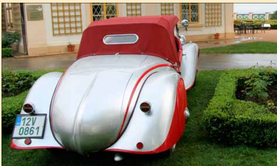
Zajímavým konstrukčním prvkem je samostatně otevíratelný spodní díl kapoty. Je pod ním schovaná nejen rezerva, ale dostatek místa i pro zavazadla. Nad výklopným víkem je třetí nouzové vyklápěcí sedadlo které pojme dospělou osobu i při úplně schované střeše. Ta je důmyslně stažená za předními sedadly
