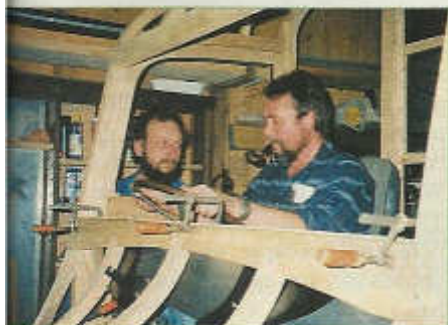
Wichtig geformt: Die ausgefallenen Wölbungen der Karosserie erschwerten den Rohbau
