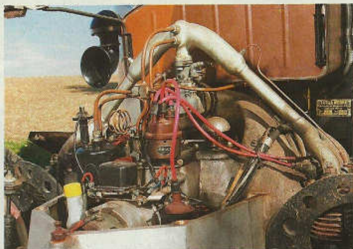
Bestens zugänglich: Die große Motorhaube schwingt weit auf und gibt den Blick auf den Vierzylinder-Boxer frei, der eigentlich kein Boxer ist. 32 PS leistet das 1910-Kubik-Triebwerk – und die haben reichlich zu tun!
