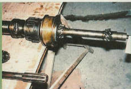
Detail der Kraftübertragung: Tatrass durchdachtes Baukastenprinzip machte es relativ einfach...
