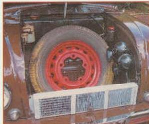
Radiateur d'huile, une ou deux roues de secours, batterie, réservoir de liquide de frein, réserve de graisse, batterie et réservoir de carburant. Il reste de la place pour... une brosse à dents.
