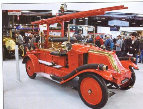
Lastwagen Renault Type LO von 1926: Mit einer Motorpumpe ausgerüstet erlaubt er eine effizientere Brandbekämpfung.
