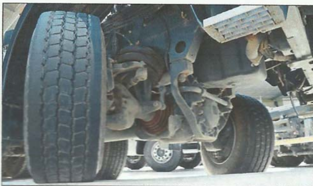
Untersicht: Hier herrschen grobe Stahlbauteile vor – links ein Blick auf die Vorderachskonstruktion, rechts auf die Hinterachsen (von hinten).
