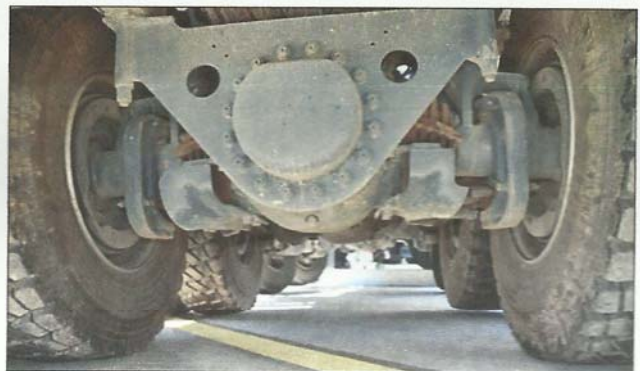
Untersicht: Hier herrschen grobe Stahlbauteile vor – links ein Blick auf die Vorderachskonstruktion, rechts auf die Hinterachsen (von hinten).
