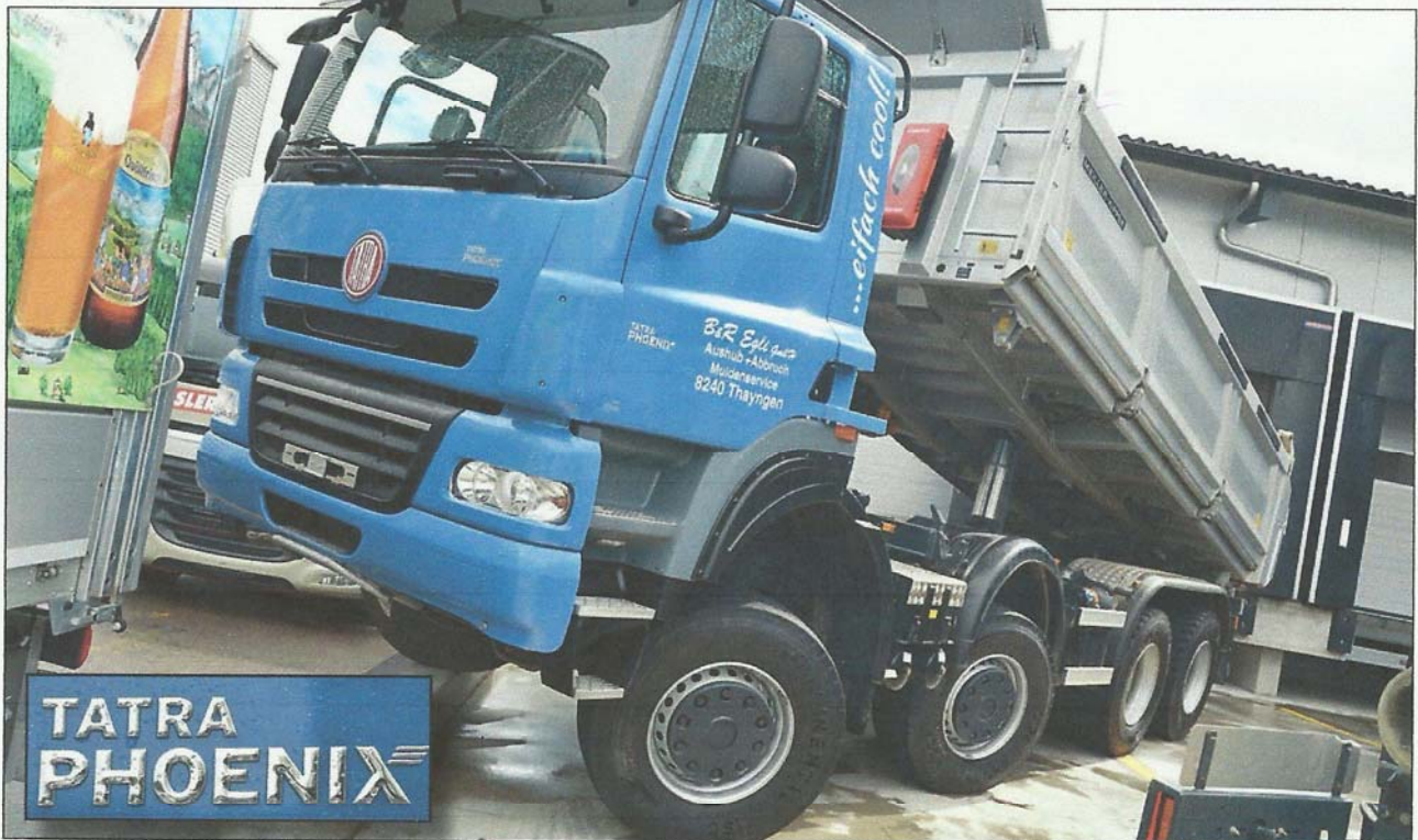
Phoenix-Tatra: Nur das Chassis mit der hohen Verwindung und extremer Geländetauglichkeit ist von Tatra, Kabine und Triebstrang stammen von DAF.
