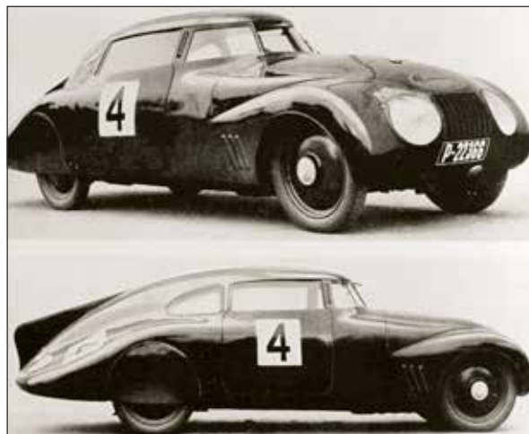
Jarayova aerodynamická karoserie na podvozku Jawa 700 pro závod 1000 mil československých v roce 1934
