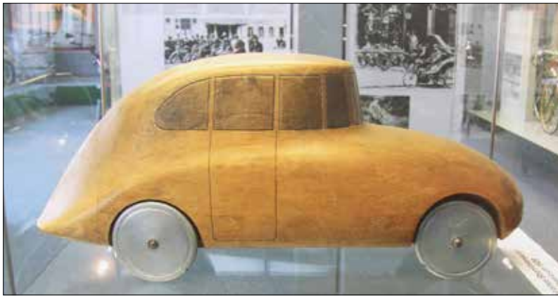
Jeden z prvních Jarayových dřevěných modelů pro měření v aerodynamickém tunelu
