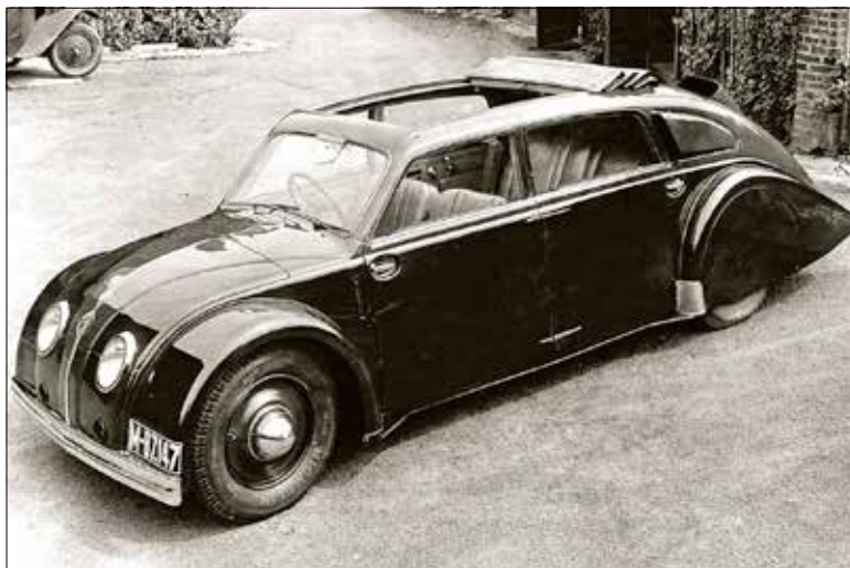
Prototyp z roku 1934 se zapuštěnými světlometry a jinak uspořádanými nasávacími otvory
