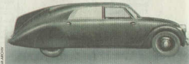
EIN MYTHOS Hier ein Modell 77A von 1935/36 (luftgekühlter V8-Heckmotor, 3380 cm 3 , 70 bis 75 PS bei 3500/min, 540 cm lang, 150 km/h Spitze).
