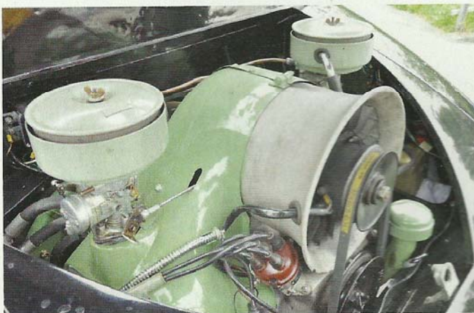
Der Tatraplan wird von einem luftgekühlten 1952-ccm-Boxermotor mit 52 PS angetrieben, der seine Kraft über ein Vierganggetriebe mit Lenkradschaltung überträgt, die den 1200 kg schweren Wagen auf bis zu 130 km/h beschleunigt.
