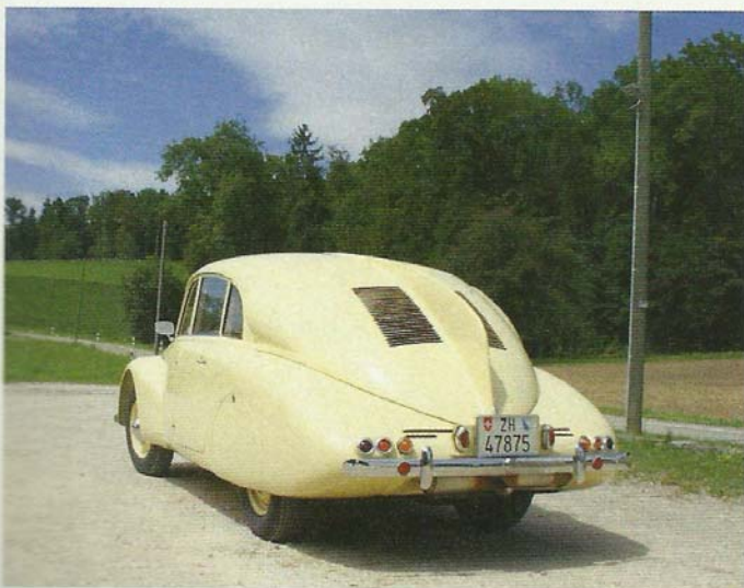
Im Gegensatz zum Vorgängermodell, dessen Stahlcarrosserie über ein Holzgerippe gezogen war, hatte der T87 eine halbselbsttragende Carrosserie mit Mittelträgrahmen und Y-förmigen Auslegern. Hans Ledwinkas Handschrift, zweifelsohne!
