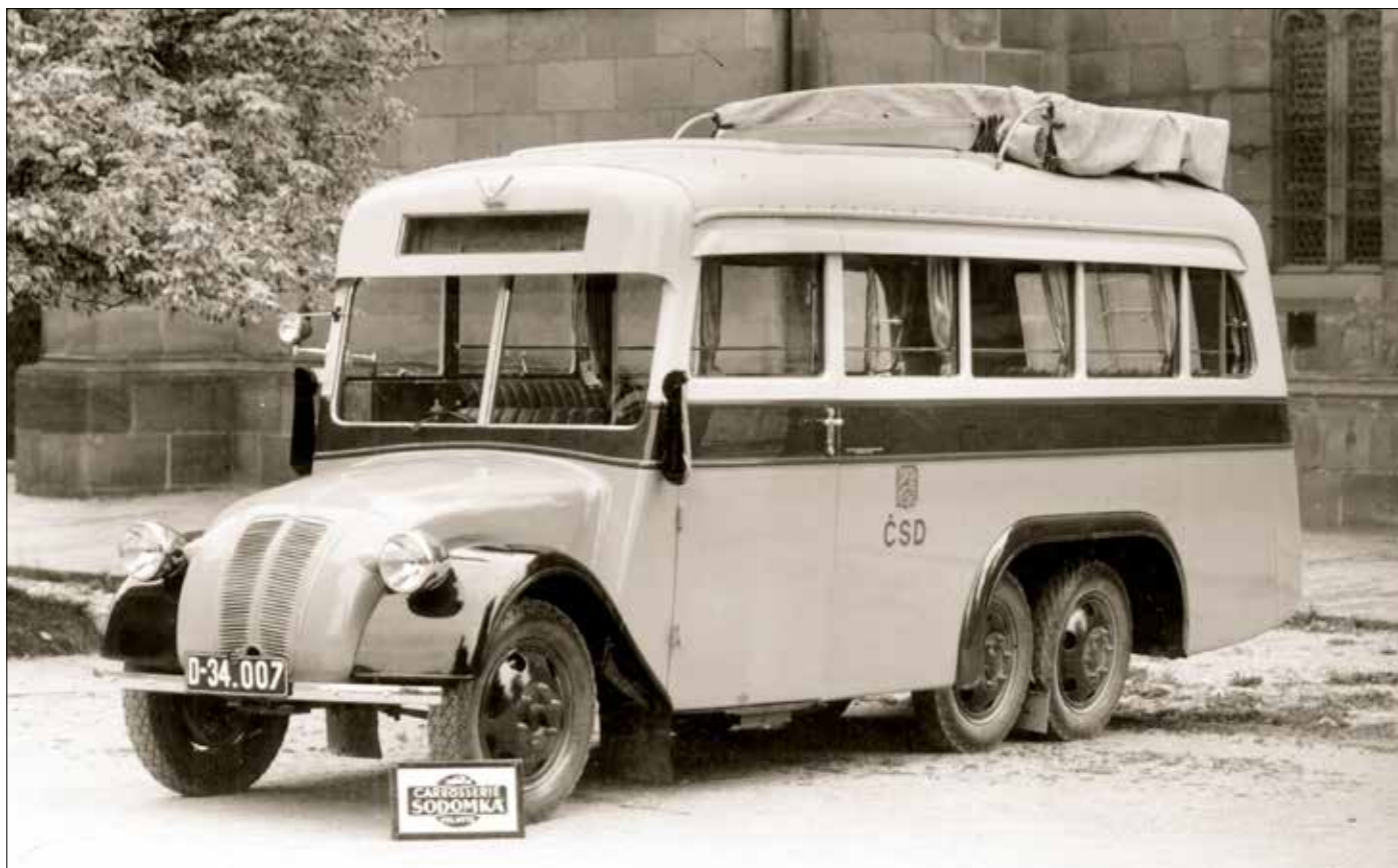
Zbývajících jedenáct autobusů Tatra 82 dodala v roce 1937 Československým státním drahám karosárna Sodomka Vysoké Mýto
