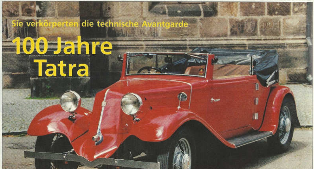
Tatra Typ 52, 1930-1936: Vierzylinder-OHV-Boxermotor, luftgekühlt, 1982 cm 3 (81,5×95 mm), 30 PS bei 3000/min. Zentralrohrrahmen, hydraulische Bremsen, ca. 110 km/h. Spezial- Cabrioletkarosserie von Sodomka.
