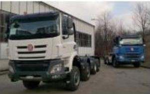
Die zwei ersten **TATRA Phönix** der neuesten Euro 6 Generation sind in Rickenbach eingetroffen. Dabei handelt es sich um ein Kundenfahrzeug in 6x6 Ausführung mit 2 gelenkten Achsen und dem 440 PS MX 11 Motor. Das zweite Fahrzeug ist ein 8x8 Chassis mit 3 gelenkten Achsen. Dieses 4-Achs Fahrzeug wird in Kürze mit einem Trösch-Kipper komplettiert für beeindruckende Fahrerlebnisse zur Verfügung stehen. An der BAUMA München begrüßen wir Sie gerne auf dem TATRA Stand.
